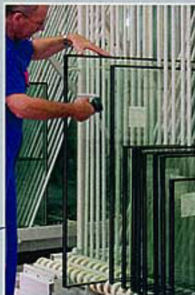
Besonders auch beim Verglasen spielt E-Prod seine Vorteile aus: Nachdem das Barcode-Etikett des zu verglasenden Flügels eingescannt wurde, zeigt der Bildschirm unmittelbar auch die Fachnummer an, in dem sich die zugehörige Scheibe befindet (BM-Fotos: Christian Nördemann)
