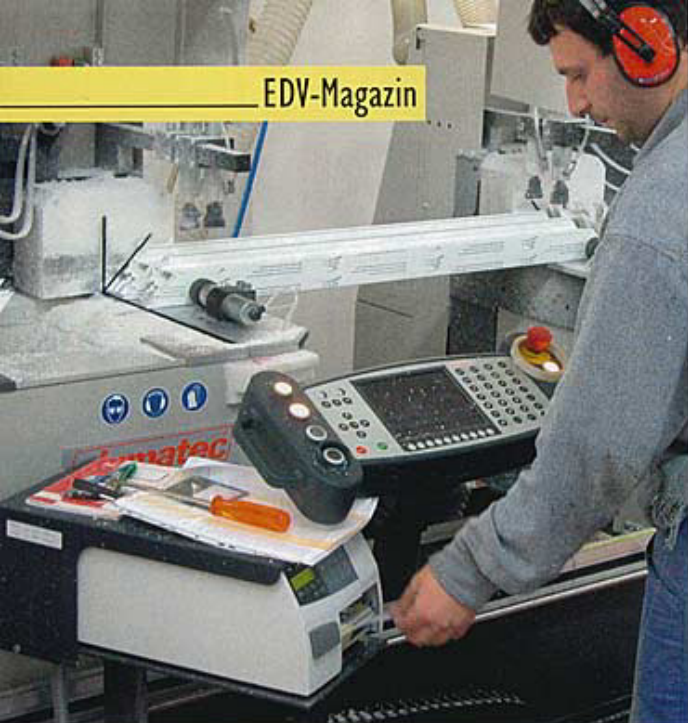
Basis für alle weiteren Bearbeitungen ist das Barcode-Etikett, mit dem alle Teile bereits beim Zuschnitt versehen werden
