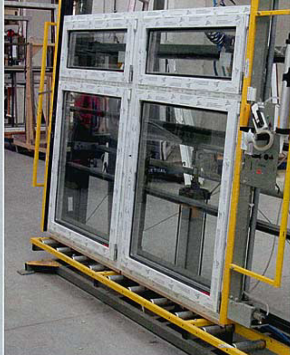
Besonders auch beim Verglasen spielt E-Prod seine Vorteile aus: Nachdem das Barcode-Etikett des zu verglasenden Flügels eingescannt wurde, zeigt der Bildschirm unmittelbar auch die Fachnummer an, in dem sich die zugehörige Scheibe befindet (BM-Fotos: Christian Nördemann)
