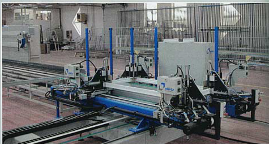
Die beiden neuen Fertigungslinien für Kunststofffenster bei Slovaktual sind mit hochmodernen Maschinen bestückt – hier: Vierkopf-Schweißautomat von Stürtz
