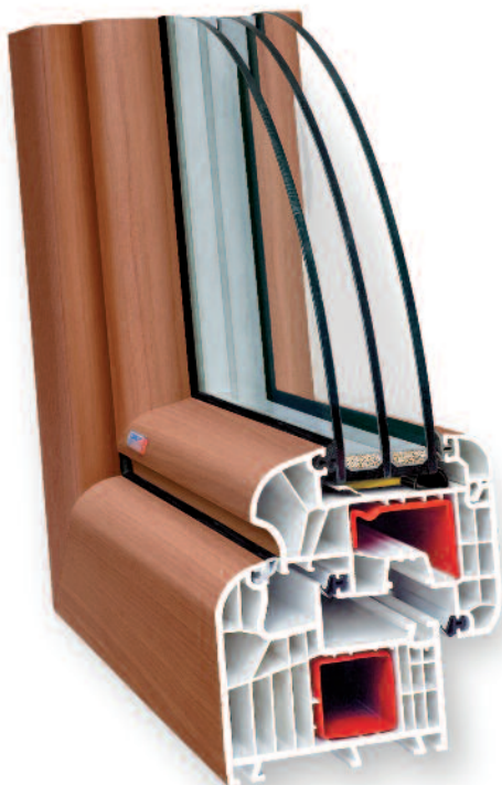
Slovaktual PASIV - OL farebné vyhotovenie. Stavebná hĺbka 85 mm s oblými líniami. Pri štandardnom zasklení 4-16-4-16-4 mm s U_g = 0,6 \text{ W/m}^2\text{K} dosahuje súčiniteľ prechodu tepla celého okna U_w = 0,8 \text{ W/m}^2\text{K} .
