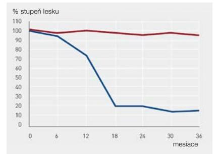
**POZNÁMKA:** Používané práškové laky Qualicoat 2 alebo Master obstáli v teste "Florida". Tento test trvá 36 mesiacov a simuluje obdobie 10 rokov v stredoeurópskom klimatickom pásme.
