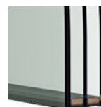
Zvenčí i zevnitř 8mm bezpečnostní VSG sklo se 4 bezpečnostními foliemi
